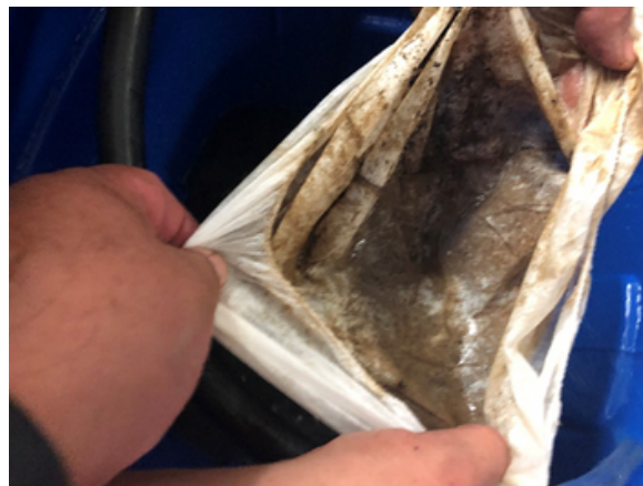
Filtro tipo bolsa saturado por acumulación de lodos y sólidos suspendidos evidencia de la carga contaminante del sistema
